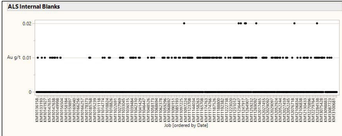
Figure 11-23: Control chart for ALS internal blanks
